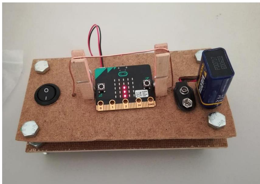
Pokus se izvodi u kratkom vremenu jer je baterija spojena na ovaj način u kratkom spoju.
